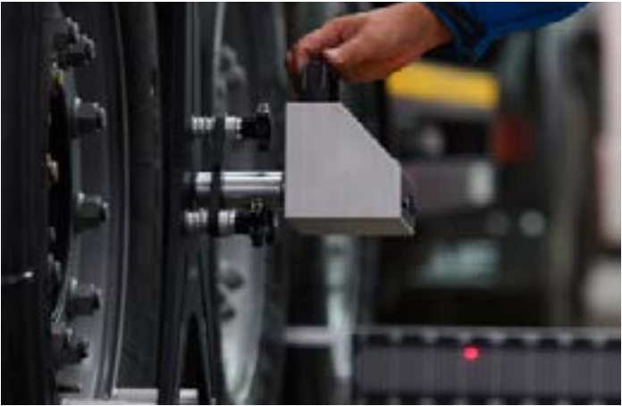
Laserowy pomiar kształtu ramy oraz kątów poziomych geometrii układu jezdnego pojazdu użytkowego.
