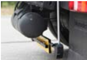
Mocowanie liniałów synchronicznych w punktach bazowych ramy nośnej.
