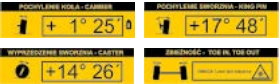
Elektroniczny pomiar kątów pochylenia kół pojazdu
